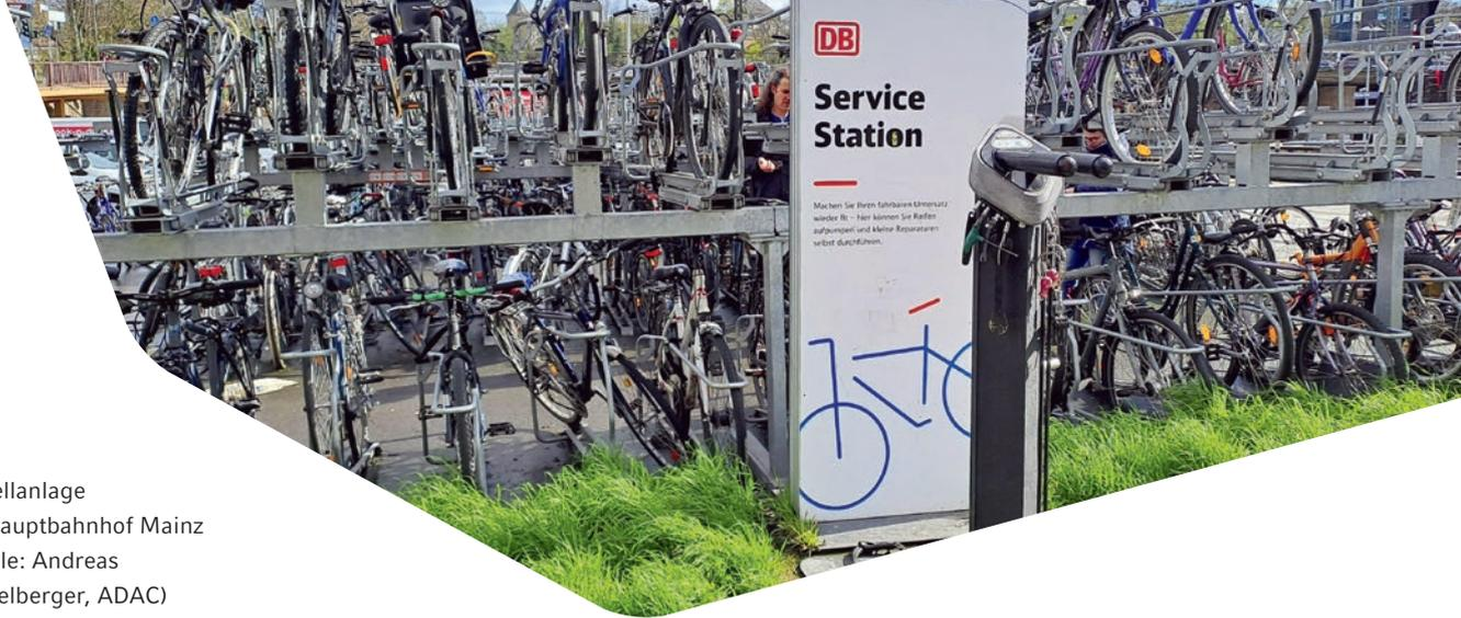
Abbildung 5 (oben): Doppelstockparker in den Innenbereichen einer Abstellanlage engen die Sichtbeziehungen ein (Quelle: Eigene Darstellung).
